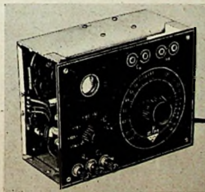
Vorderansicht. Über dem Bereichsschalter befindet sich das Magische Auge als Nullanzeiger
