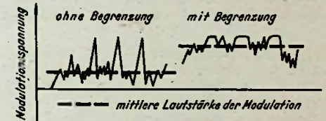
Abb. 6. Unbegrenzte und begrenzte Modulationsspannung
